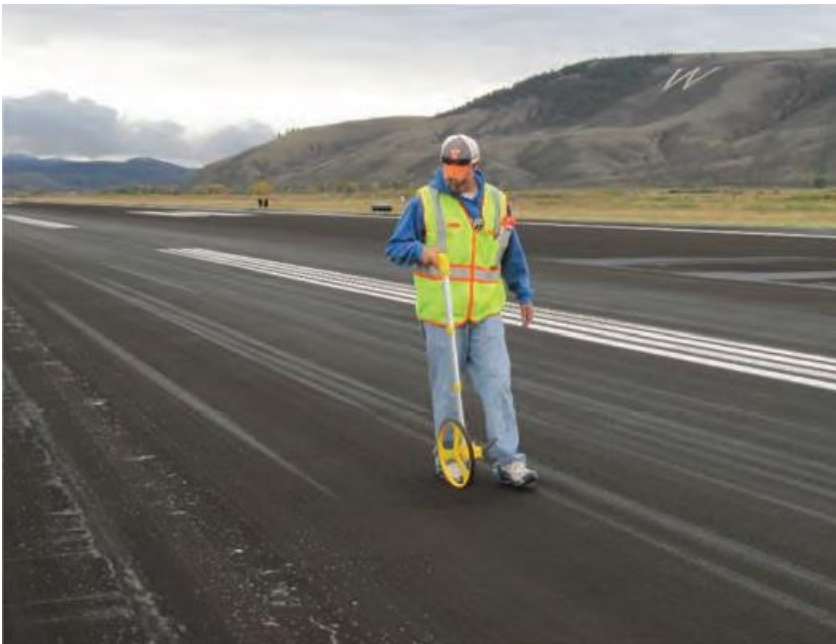
Figura 9. Inspección manual de condición visual utilizando rueda de medición para registrar las dimensiones de los deterioros.
