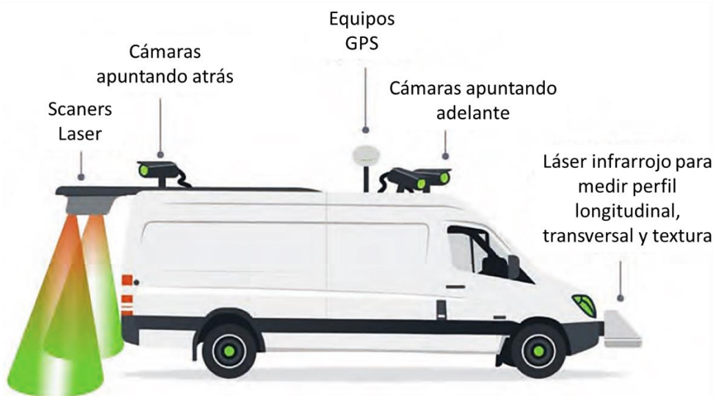
Figura 15. Vehículo equipado con imágenes en 3D-láser y otros sensores.
