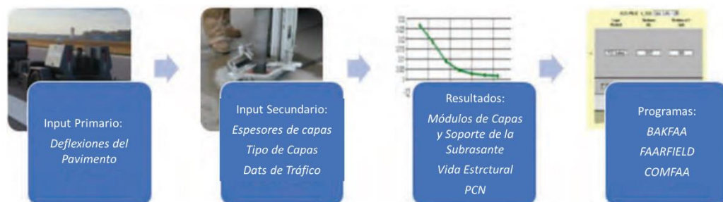
Figura 8. Relación entre los datos de deflexión y usos (BAKFEE, FAARFIELD y COMFAA son programas de diseño de aeropuertos).
