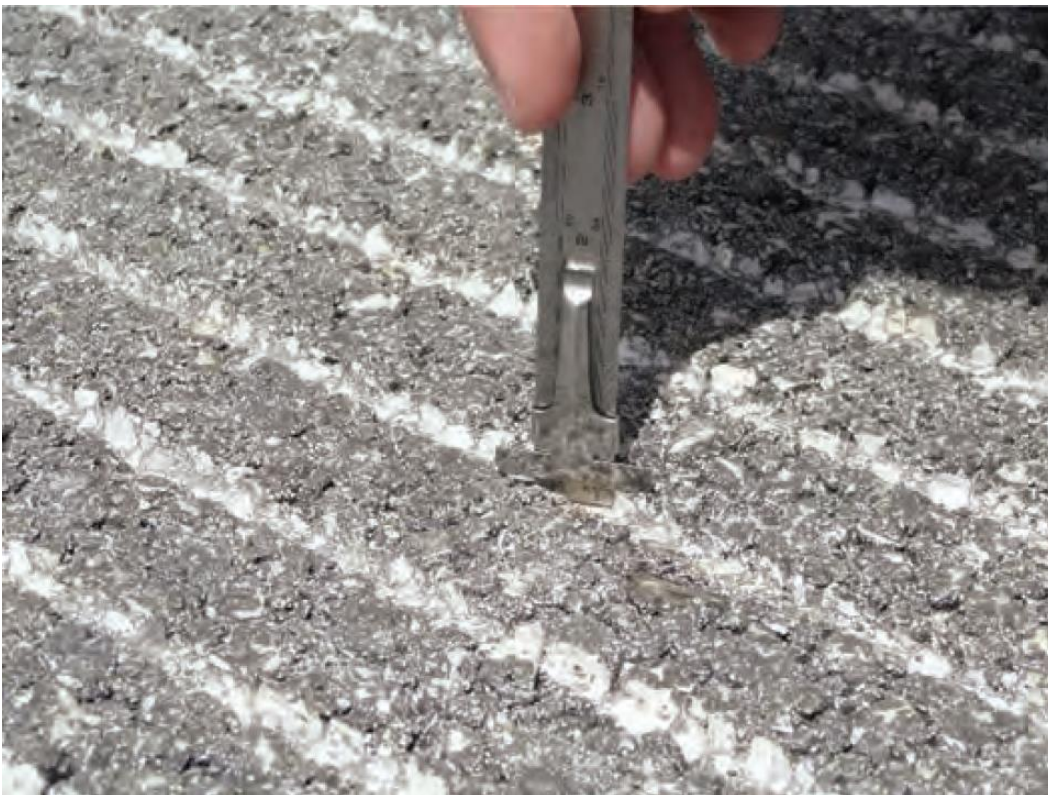
Figura 17. Medición manual de la profundidad de las ranuras de la pista.
